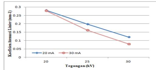
**Gambar 7.** Hubungan koefisien atenuasi linier dengan tegangan (kV)
